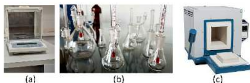
Figura 2: Equipamentos utilizados nas atividades práticas: a) balança analítica; b) picnômetros; c) mufla.
