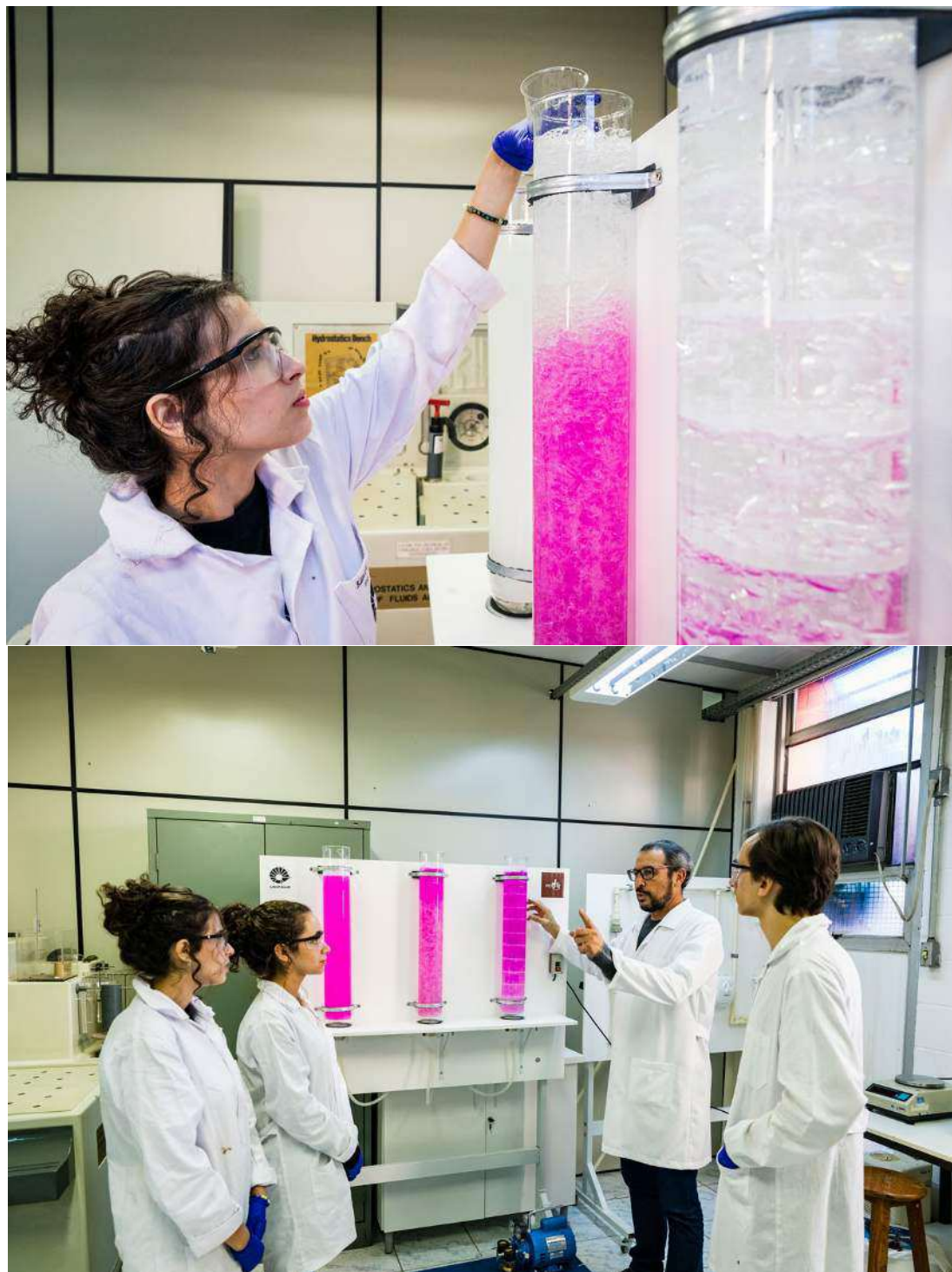
Experimento de determinação de coeficiente de dispersão axial em colunas de bolhas finalizado e operacional. (Fonte: Felipe Bezerra/Jornal da Unicamp).
