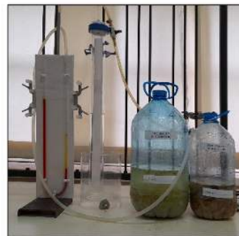
Figura 3: Biodigestor construído em escala de bancada.
