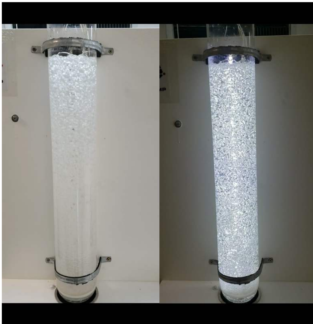
Coluna de bolhas (sem recheio) antes e depois da instalação da iluminação de LED. (Fonte: Acervo PET-EQ UNICAMP)
